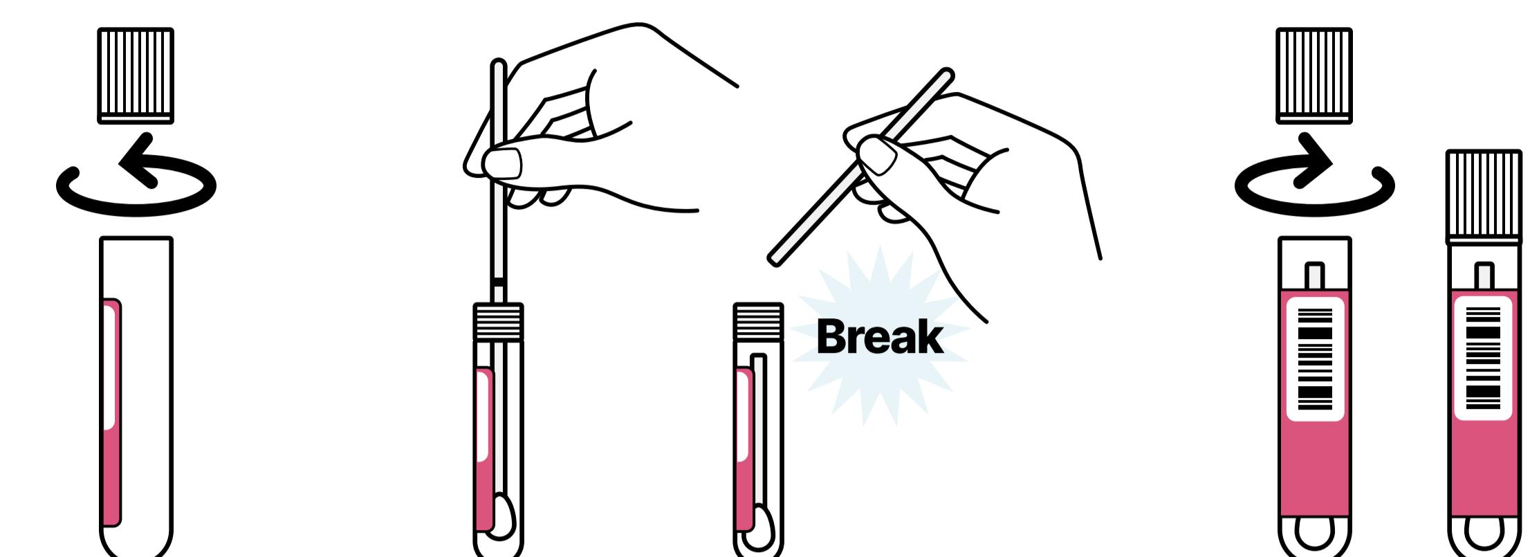
Plaats de swab in de buis en breekt deze af op het zwarte lijntje. Laat het gedeelte met het watje in de buis zitten en gooi het afgebroken stuk weg. **Let op:** zorg ervoor dat de buffervloeistof in de buis blijft zitten.
